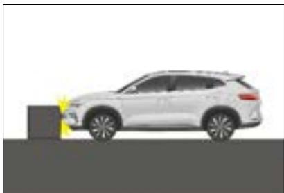
Wenn Sie einen steilen Abhang hinunterfahren, schlägt die Nase des Fahrzeugs auf dem Boden auf.
