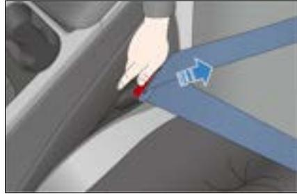
4. Für optimalen Komfort und Schutz kann die Höhe der Sicherheitsgurte eingestellt werden.
