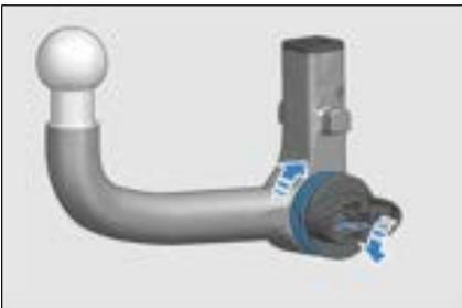
5. Greifen Sie die Anhängervorrichtung von unten fest und richten Sie die Dreiecksmarkierungen auf beiden Seiten der Anhängervorrichtung mit den entsprechenden Aussparungen im Kupplungsgehäuse aus.
