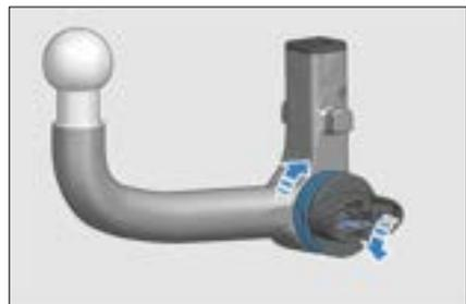
5. Greifen Sie die Anhängervorrichtung von unten fest und richten Sie die Dreiecksmarkierungen auf beiden Seiten der Anhängervorrichtung mit
