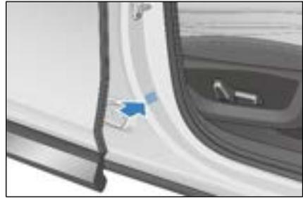
Das Etikett des Ladeanschlusses ist an der Tür des Ladeanschlusses angebracht.
