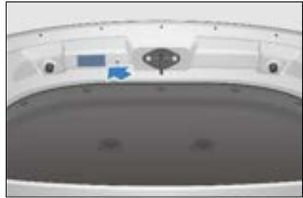
Das Batteriepositionsetikett ist unterhalb des seitlichen Airbagetiketts auf der rechten B-Säule angebracht.
