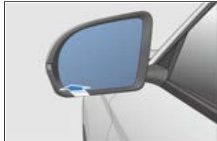
Der Fahrer kann den elektrischen Außenrückspiegel über seinen Schalter in eine Position bringen, in der der Fahrer die Seite des Fahrzeugs im Außenrückspiegel sehen kann.
