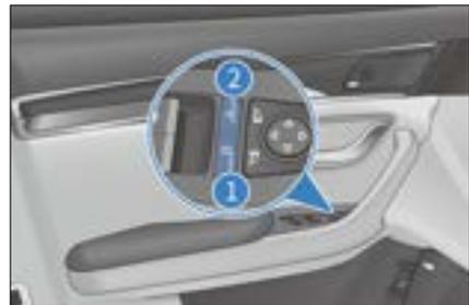
Drücken Sie die zentrale Entriegelungstaste, um alle Türen zu entriegeln. Sobald die Türen entriegelt sind, erlischt die Tastenanzeige.
