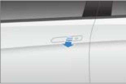
3. Stecken Sie den mechanischen Schlüssel in das Schlüsselloch und drehen Sie den Schlüssel.
