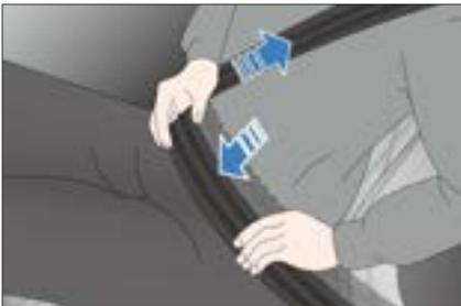
3. Schieben Sie den Riegel in die Schnalle, bis er einrastet, und ziehen Sie ihn dann zurück, um sicherzustellen, dass er fest verriegelt ist. Schließen Sie den Gurt nicht, wenn ein Teil des Gurtes verdreht ist.
