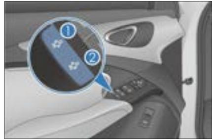
Drücken Sie zum Aktivieren des Kindersicherungs-Schlusses Kindersicherungstaste ① oder ②. Die entsprechende Anzeige leuchtet auf. Zu diesem Zeitpunkt können die Insassen die hintere Tür auf der entsprechenden Seite nicht öffnen. Drücken Sie zum Entriegeln der Tür erneut die Kindersicherungstaste für die jeweilige Seite oder benutzen Sie den äußeren Türgriff.
