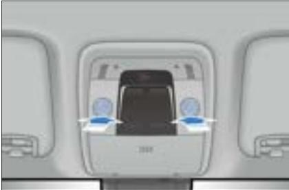
Ladeanschluss-Konfiguration II: Der vordere Innenraumlichtschalter
