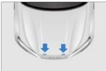
4. Prüfen Sie nach dem Schließen der Motorhaube, ob der Riegel sicher verriegelt ist.
