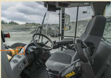
A nova linha de máquinas pesadas possui cabines com certificação ROPS e FOPS, garantindo a segurança do operador contra queda de objetos e capotamento.
