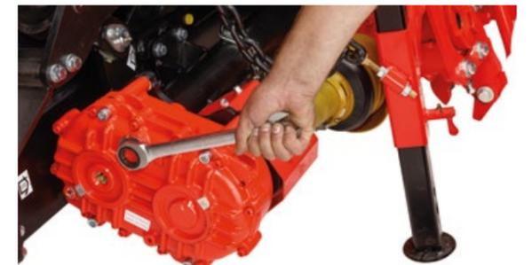
Durch das Multispeedgetriebe mit vier Gängen kann die Vorsatzgeschwindigkeit – mit oder ohne variablen Vorsatzantrieb – an jede Schnittlänge ideal angepasst werden.
