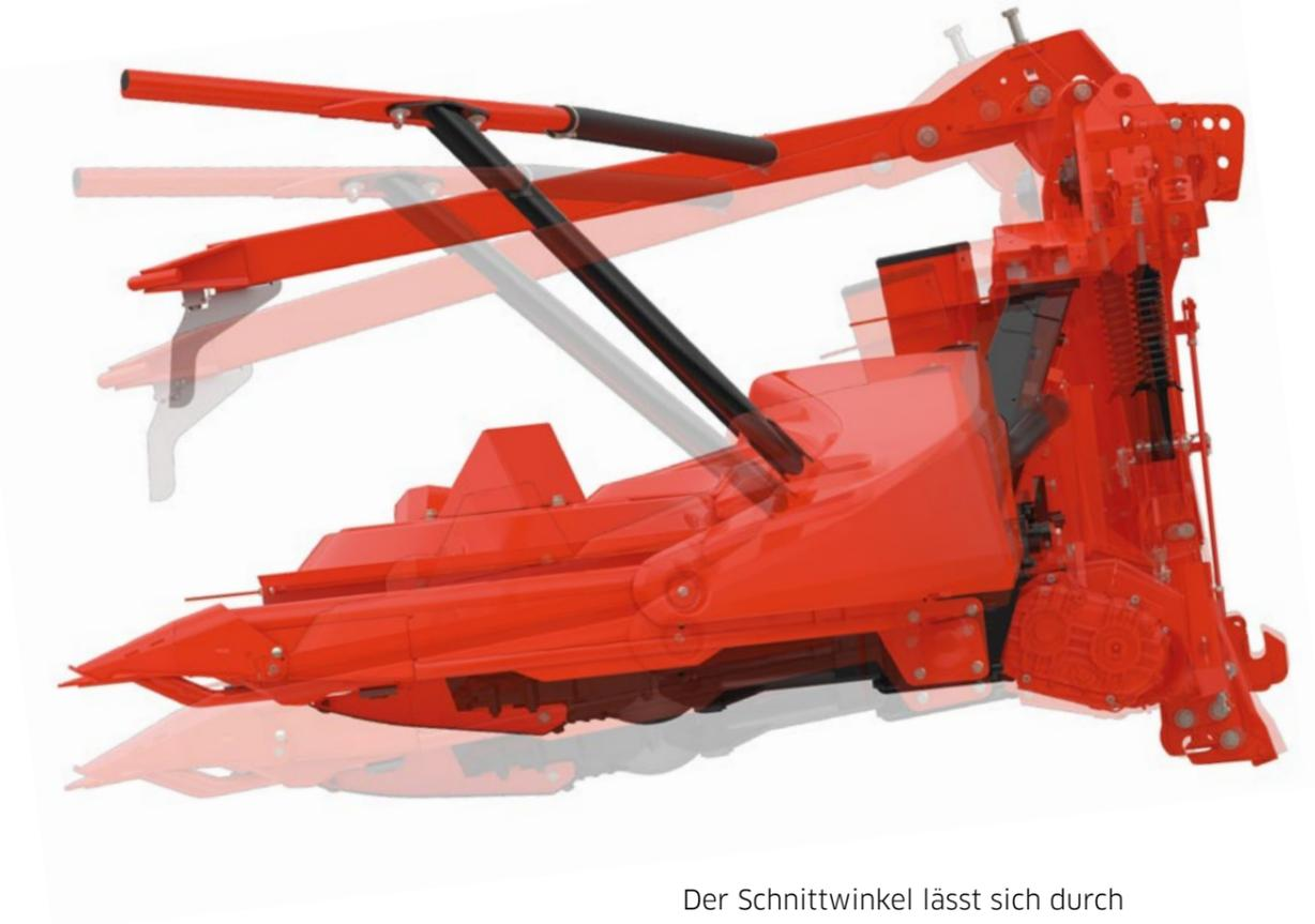
Der Schnittwinkel lässt sich durch den Verstellrahmen einfach anpassen.
