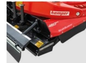
Anpressdruck der Einheiten über ein Regelventil möglich, dadurch kaum Bodenkontakt. Exakte Bodenführung durch einzeln pendelnd aufgehängte Einheiten.
