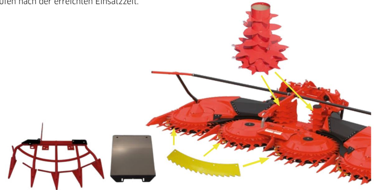
Viele Komponenten sind als HD-Varianten verfügbar, die eine erhöhte Lebensdauer garantieren und unnötige Reparaturen in oder nach der Ernte vermeiden.
