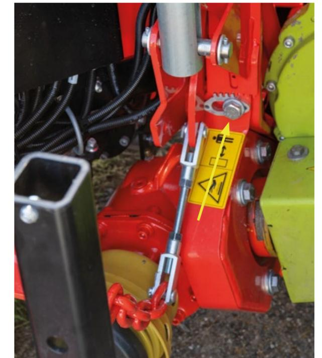
Durch den optionalen einstellbaren Anbauwinkel lässt sich der Vorsatz immer passend zum Boden einstellen – unabhängig von der Reifengröße.
