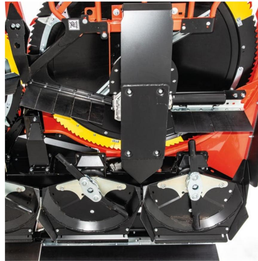
Pneumatisches Drucksystem für ein sanftes Folgen der Bodenkontur. In Grundrahmen integrierter Pneumatikzylinder. Automatisches Ausheben der Mulcheinheiten beim Rückwärtsfahren.
