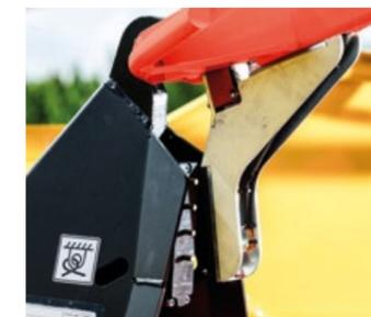
Die Kupplung der integrierten Beleuchtung erfolgt völlig selbstständig.
