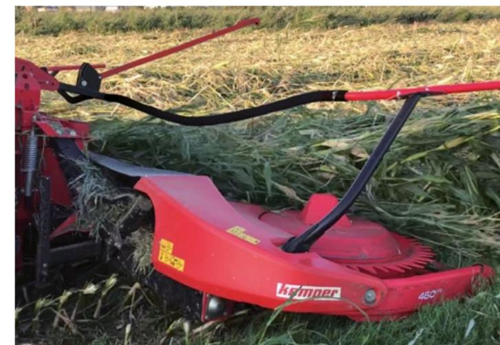
Durch die flache Bauweise wird Lagermais behutsam auf die großen Fördertrommeln geleitet und sicher zum Häcksler befördert. Das verringert Blockaden und die Notwendigkeit zum Reversieren.
