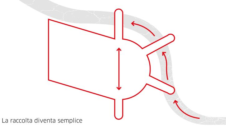
L'aspo di raccolta di piccolo diametro del C3003 solleva qualsiasi tipo di raccolto senza spingerlo in avanti. La coltura corta, risultato dell'ultimo taglio, non "rotola" davanti alla barra pickup, ma viene prelevata direttamente, creando così la base per ottenere un flusso di
