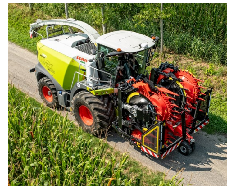
Le système d'éclairage intégré s'active automatiquement lorsque la tête de récolte est repliée.
