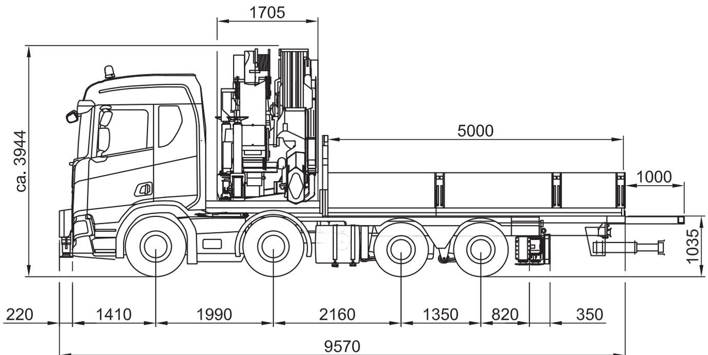
2413/ 4-Achs Scania mit Palfinger 7S mit Jib 5S + 2 Handauszüge
