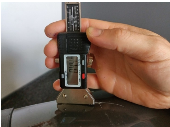
Sposób pomiaru głębokości uszkodzenia
