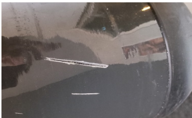
Przykładowe uszkodzenie poziomu 2 (przecięte)
