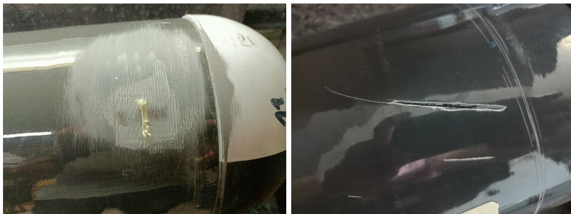
Przykładowe uszkodzenia poziomu 3 spowodowane ścieraniem lub przecięciem
