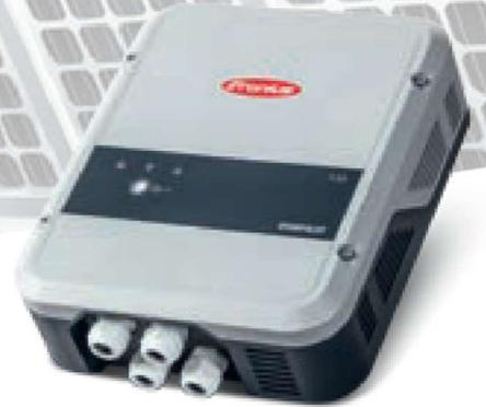
Der Fronius Ohmpilot ist ein Verbrauchsregler, der überschüssigen PV-Strom zur Warmwasseraufbereitung heranzieht. Dank der stufenlosen Regelung von 0 bis 9 kW kann der überschüssige PV-Strom effizient genutzt und an eine Wärmequelle im Haushalt weitergegeben werden.
