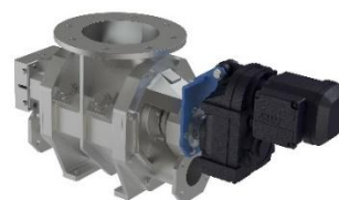
Blow-through cellmatare ZSD För inmatning av bulkmaterial in i blåstransporter. Maximalt tömnings tryck - 0,8 / + 0,8 bar
