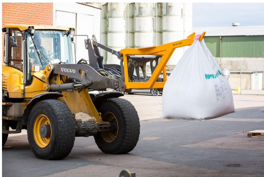
Truckok för hämtning av säck. Finns för 1, 2 eller 3 enöglesäckar samtidigt.
