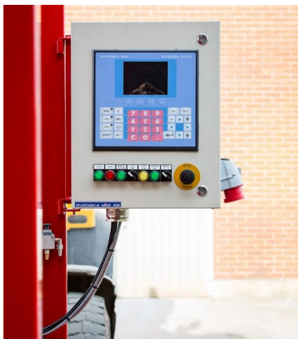
Enkelt styrsåkåp för smidig hantering av fyllningen.
