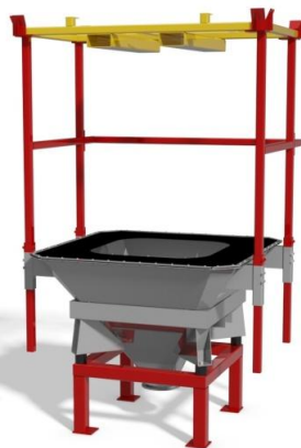
BAGBOY ONE WAY typ B Golvstativ (10b) med tömmarskål (4), gummimanschett (3), kniv (2), säckupphängningsstativ (1b) och ok för truck eller kran (18c).
