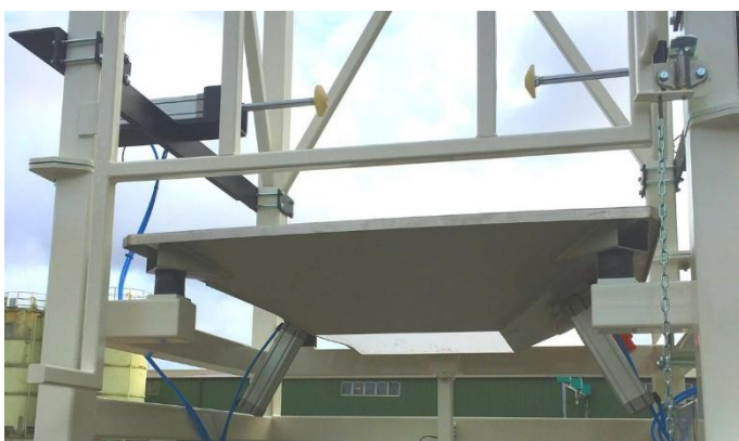
I stativet är knådarna i ytterläge. Det finns ytterligare två knådare i säckstödet som underlättar säcktömningen.
