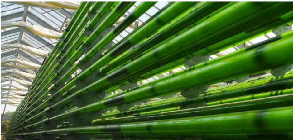
**foodunfolded – In wassergefüllten Röhren wachsen Mikroorganismen unter nahezu perfekten Bedingungen: CO<sub>2</sub>-Sättigung, Nährstoff- und Salz-Gehalt können hier präzise eingestellt werden.**
