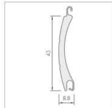
\*Die vom Systemanbieter empfohlene Stabilität des Panzers wird für Flächen bis zu 7 m<sup>2</sup> erreicht. Oberhalb dieses Wertes können leichte Wellenbildung im Panzer auftreten – dies beeinflusst jedoch nicht die Funktionalität, und der Rollladen erfüllt alle in der Norm festgelegten Kriterien.
