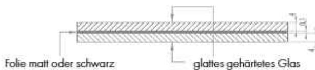
Standard-VSG/ESG geklebt und gehärtet,
