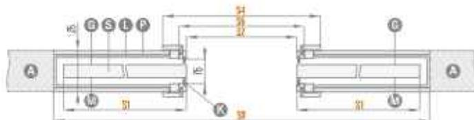
Breite des Kastens vor der Beplankung mit GK-Platten: 100 mm
