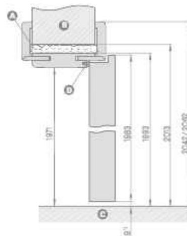
**A** Schaum **B** Mauer **C** Boden **D** Anschluss
