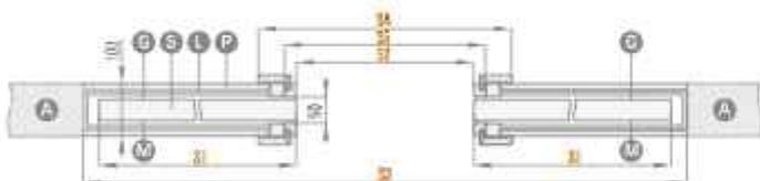
Breite des Kastens vor der Beplankung mit GK-Platten: 75 mm
