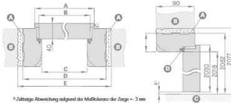
\* Zulässige Abweichung aufgrund der Maßtoleranz der Zarge + 3 mm (wie empfohlen, das vor der Montage zu überprüfen)
