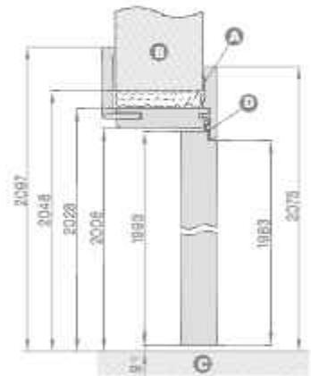
**A** Schaum **B** Mauer **C** Boden **D** Gummi Dichtung
