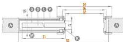
Breite des Kastens vor der Beplankung mit GK-Platten: 100 mm
