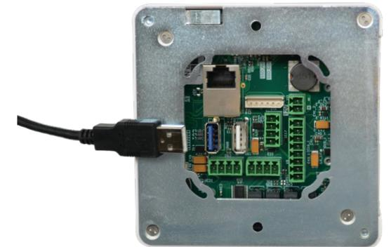
Verbinden Sie das LED-Kabel (ein Signalkabel für die LED - Lichter am Sensor) mit der weissen Buchse am Controller.
