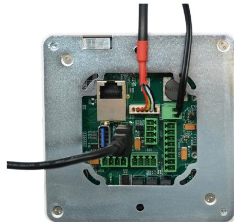
Verkabeln Sie nun das oder die Relais mit Ihrer Türschaltung. Dazu benötigen Sie ein Stromkabel, welches den Impuls an die Tür / das Tor etc. weitergibt. Dieses Kabel wird meist mit der Tür geliefert und es handelt sich dabei um ein Niederspannungskabel.
