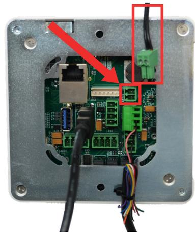
Ihre Verkabelung sollte nun so aussehen: Im Controller stecken jetzt drei Kabel. Davon gehen zwei an das Sensorgehäuse und eins zum 12 Volt Netzteil.
