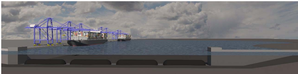
Figuur 4-21: 3D-zicht vanuit Schelde op slibkering (balg-type) met achterliggend het 2 e getijdedok
