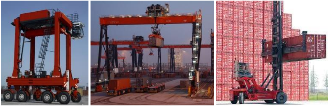
Figuur 3: Overzicht opslagsystemen: Straddle carrier (l), ASC (m) en empty handler (r)
