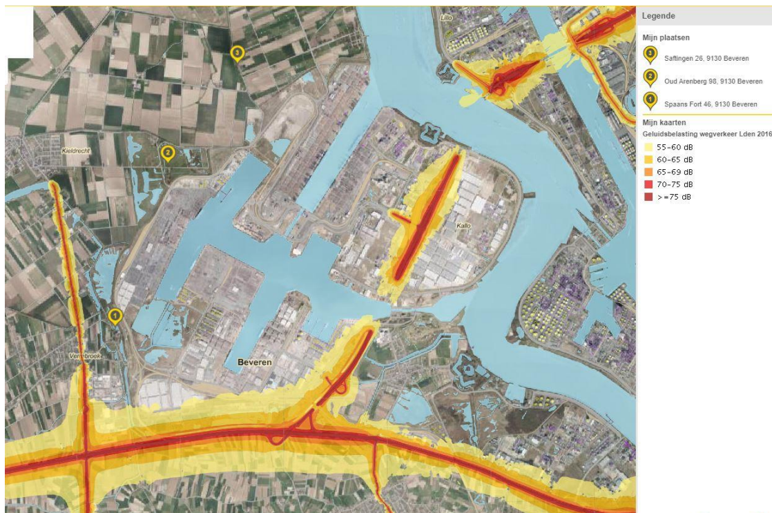
Figuur 8-3: Aanduiding voorstel meetpunten op geluidsbelastingskaart wegverkeer Lden (bron: Geopunt Vlaanderen)
