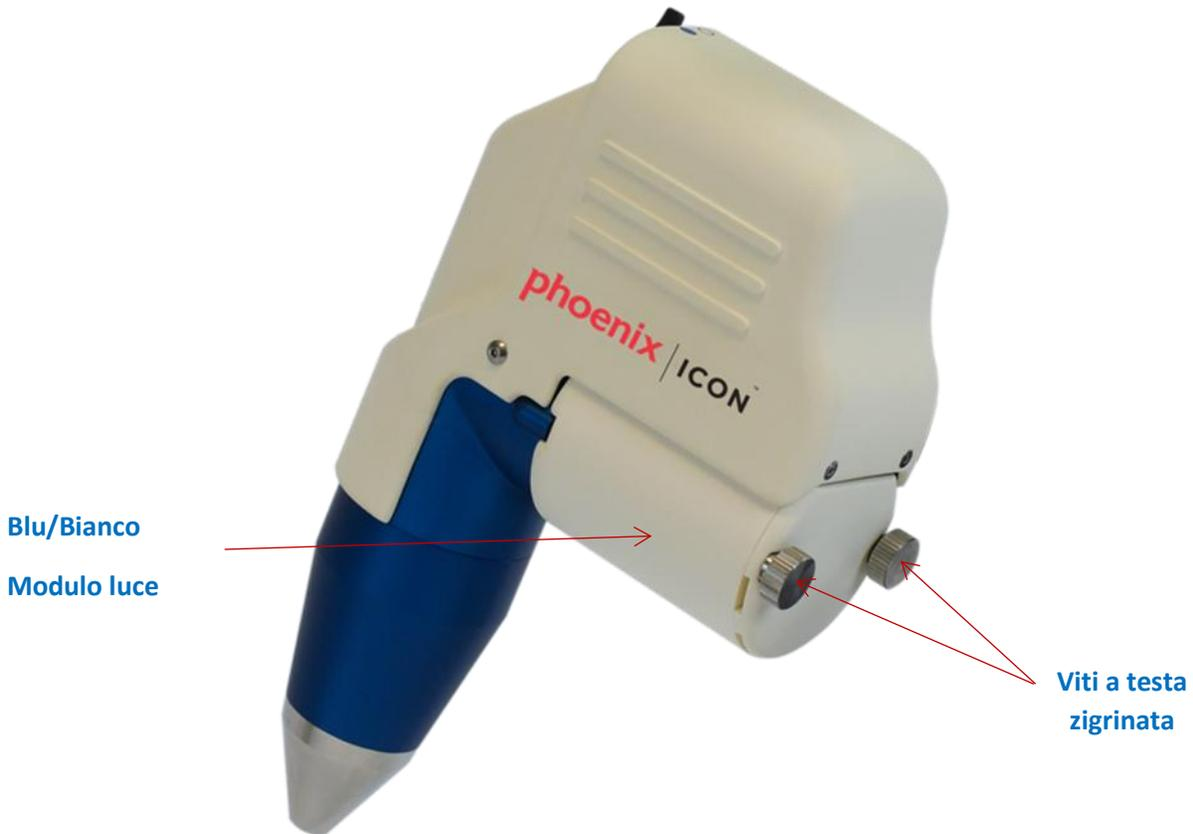
1. Allentare completamente le due viti a testa zigrinata sul retro del modulo luce; tirare indietro il modulo e rimuoverlo.
