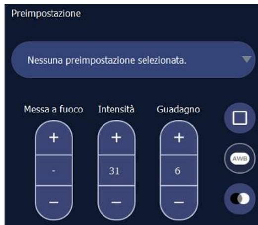
L'operatore può regolare la messa a fuoco, l'intensità e il guadagno nella sezione dei comandi della fotocamera in Comandi sistema.
