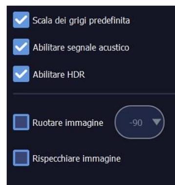
**Ruotare immagine:** quando si utilizza la fotocamera ICON, si prevede che l'operatore si avvicini al paziente supino dalla parte superiore della testa. Pertanto, l'orientamento standard della fotocamera dovrebbe essere tale che il cavo del manipolo poggi sulla linea mediana della fronte del paziente. I pulsanti **Ruotare immagine** e **Rispecchiare immagine** consentono di modificare l'orientamento standard della vista.
