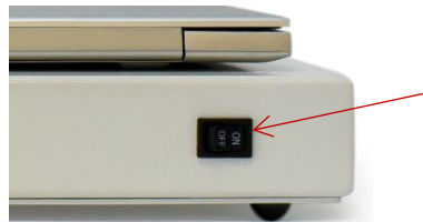
Netzschalter des Schaltkastens
