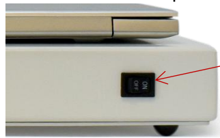
Interruptor de alimentación de control
