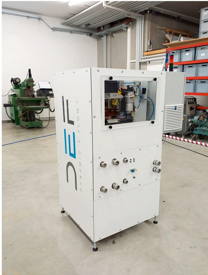
**BILD 3** Hydraulikaggregat für HC 430-054 (© Dynamic E Flow)
