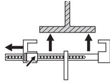
3. Cerrar el engate en la viga apretando la grampa de fijación contra la viga. Las grampas de fijación deben encontrarse cerradas en la viga simétricamente. El botón de bloqueo de la grampa debe estar bloqueado. Se debe asegurar que el engate queda fijado en la viga y no es posible su desconexión incidental.
