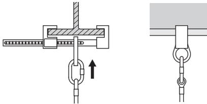
5. Unir el equipo protector contra caídas de una altura al punto de anclaje del arnés de seguridad certificado, conforme con la EN 361. El punto de anclaje del arnés debe estar marcado con la mayúscula "A".
