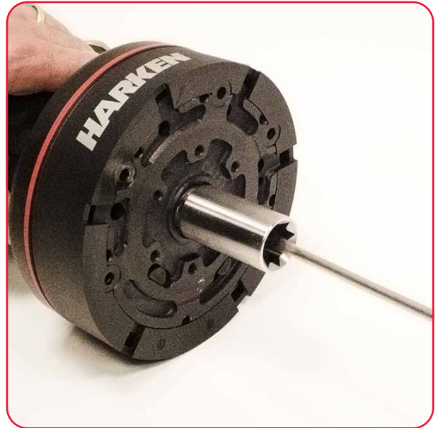
5. Bloquee el tornillo en el acoplamiento de la manivela.
