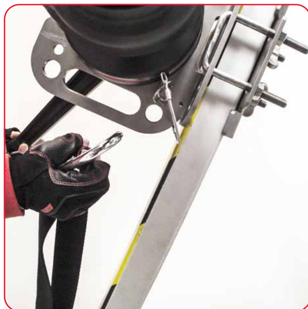
7. Conecte un conector de la correa de anclaje a la placa en el lado del Winch, y el segundo conector de la correa de anclaje a un punto de anclaje seguro en el lado opuesto.
