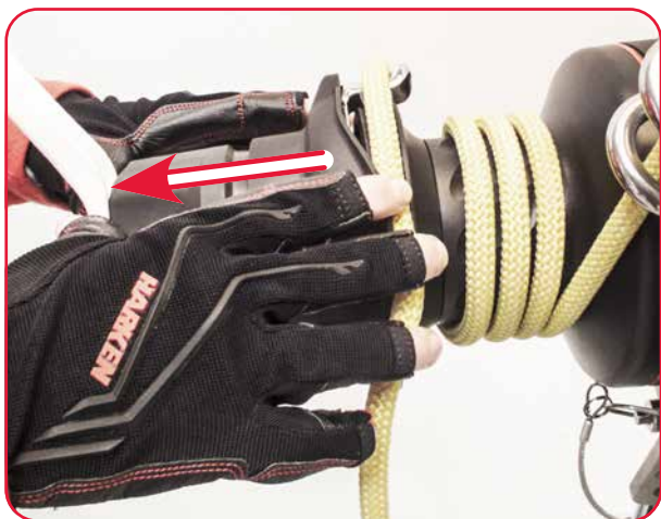
Compruebe la movilidad de la cubierta de la semi-polea.
