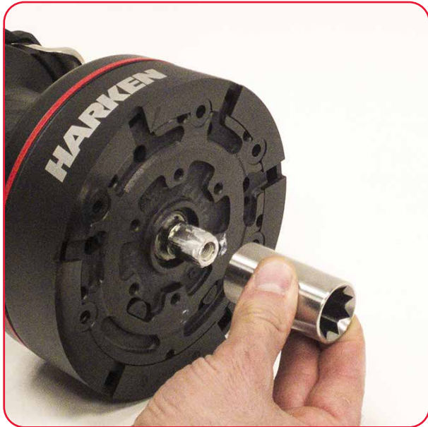
4. Coloque el acoplamiento de la manivela en el eje.
