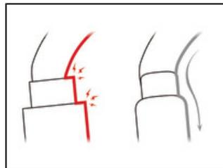
El diseño interior fluido de los mosquetones OK limita el riesgo de punto estable y facilita la rotación del mosquetón.
