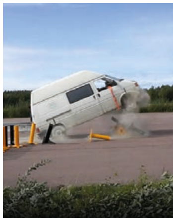
Road Barrier oskadliggör och stoppar ett fordon som framförs i en hastighet på 60 km/h.
