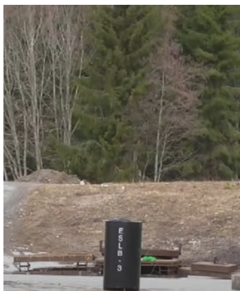
ESLB E3 i skarpt test med 3 000 g TNT.
