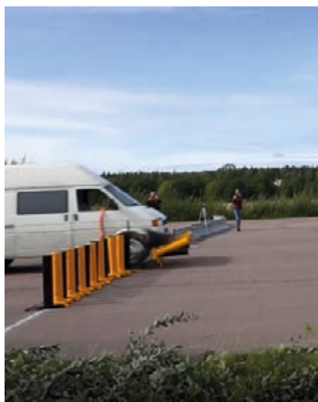
Road Barrier oskadliggör och stoppar ett fordon som framförs i en hastighet på 60 km/h.
