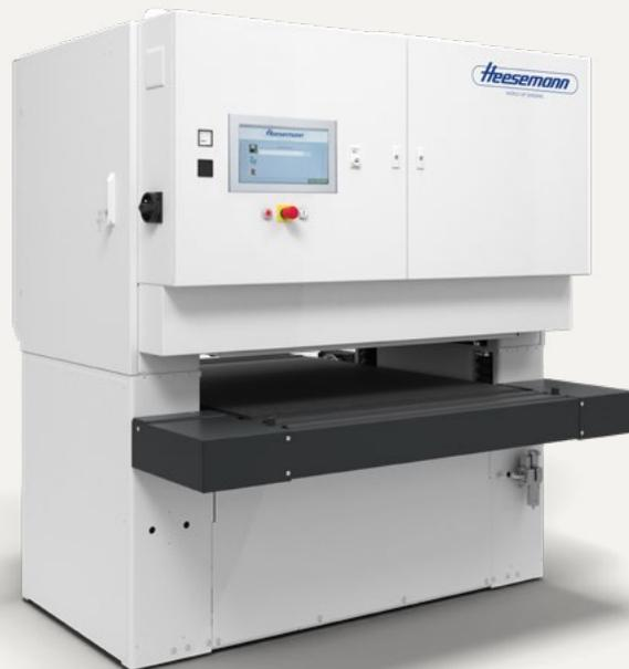
Die Lösung für **kleine** und **mittelgroße Handwerksbetriebe**: Ob als **Einbandmaschine** oder mit **2 Schleifaggregaten** - die SWT-100 erledigt alle Schleifarbeiten souverän. Dazu zählen Kalibrieren und Feinschleifen von Massivholz ebenso wie das Schleifen von Furnieren und der Lackzwischen-schliff (Option). Für Ihre Ansprüche stehen Antriebsleistungen bis zu 15 kW zur Verfügung. Zusätzlich sorgen die unabhängig voneinander angetriebenen Aggregate für ein schnelles und hochwertiges Ergebnis.
