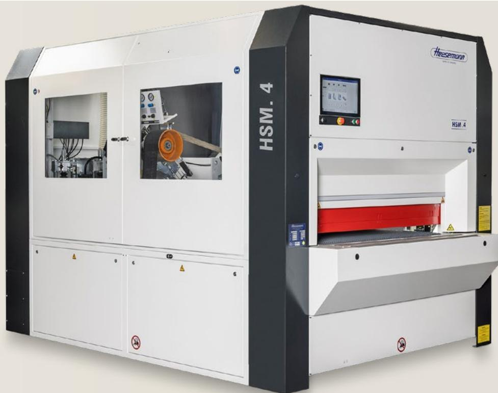
Die HSM ist der Flächenschleifautomat für **kleine** und **mittelständische Handwerks- und Industrieunternehmen**. Egal ob Effektschliff, Kreuzschliff, Lack- oder Hochglanz-schliff, ob Platten, Massivholz oder furnierte Werkstücke - die Heesemann HSM ist die optimal abgestimmte Schleifmaschine für das Handwerk! Die HSM ist dabei in ihren Standardkonfigurationen mit zwei, drei oder vier Aggregaten für alle typischen Anwendungen bestens vorbereitet.
