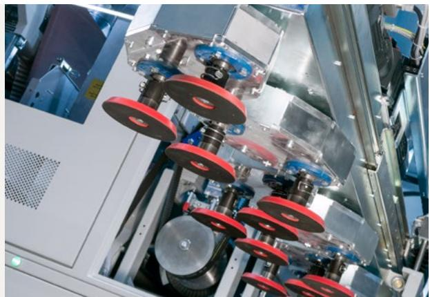
Zum einfachen Werkzeug- oder Anwendungswechsel kann das DB-S auf integrierten Schienen seitlich aus der Maschine gezogen werden. Alle Teller sind somit frei zugänglich. Dank **Schnellspannverschlüssen** kann dies innerhalb weniger Minuten erfolgen.
