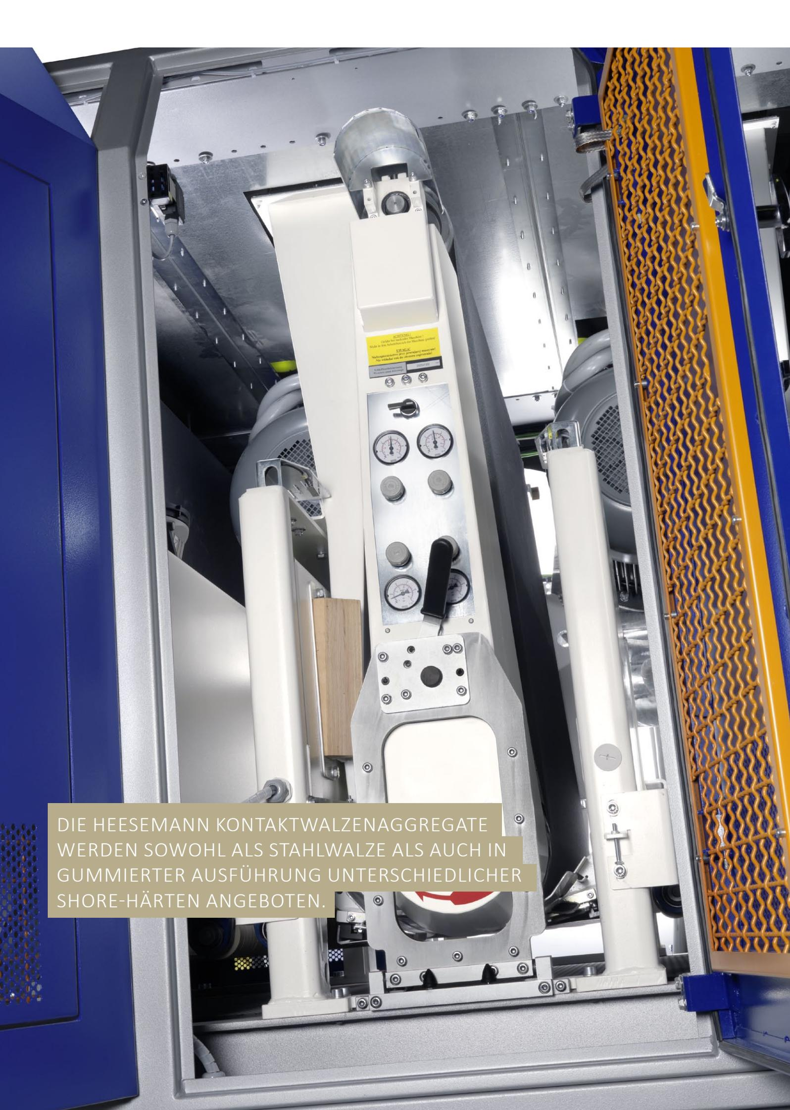
DIE HEESEMANN KONTAKTWALZENAGGREGATE WERDEN SOWOHL ALS STAHLWALZE ALS AUCH IN GUMMIERTER AUSFÜHRUNG UNTERSCHIEDLICHER SHORE-HÄRTEN ANGEBOTEN.
