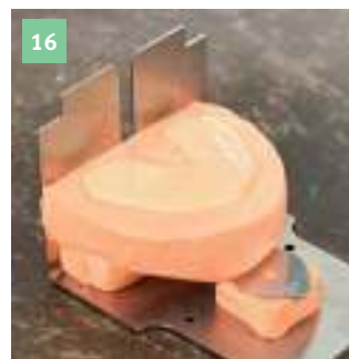
16 Om het insluiten van lucht bij het onderdompelen van de sokkelplaat te voorkomen moet de afdruk met meer gips als nodig worden gevuld.
