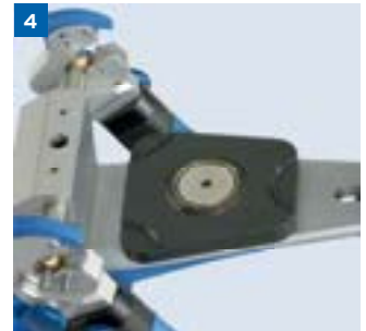
4 Splitex-Magnettopf und Magnet in TOP-Platte einbringen
