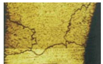
Grobkörniges Gefüge einer herkömmlichen CoCrMo-Aufbrennlegierung (V=100:1)
