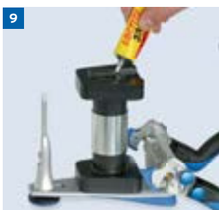
9 Splitexplatte mittig mit zwei Kleberspuren versehen
