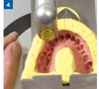
4 Bohrloch positionieren mit Hilfe des Laserpunktes und Bohrvorgang auslösen
