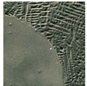
Rissfreie Lasernaht bei einer kohlenstofffreien CoCrMo-Modellguss-Legierung
