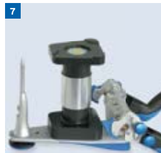
7 Artex-Artikulator auf den Kopf stellen und Splitex-Schlüssel aufsetzen
