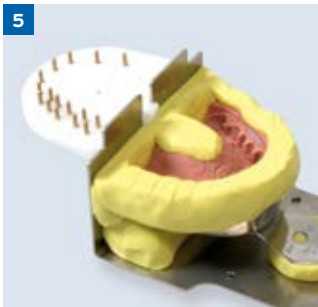
5 „Giroform-Pins sind in die Bohrungen eingesetzt, die Sockelplatte wird geparkt (wichtig wenn mehrere Modelle parallel produziert werden)“
