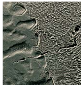
Von Carbiden ausgehende Risse bei einer kohlenstoffhaltigen CoCrMo-Modellguss-Legierung
