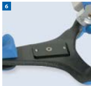
6 Klebeplatte in Artex-Unterteil einschrauben
