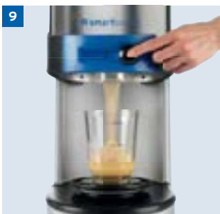
9 Smartbox - per Knopfdruck Wasser- und Gipspulver dosieren
