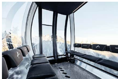
Indoor-Skihalterung durch TWIST-IN-System.
