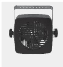
Pro9 Lautsprecher und Gehäuse Q-P9SPK Wasserdichte Mylar-Membran, Gehäuse IP64 15 Watt /30 Peak, 8 Ohm 210 bis 7000 Hz 4-poliger GX16-Stecker 117x117x73mm ohne Halterung 682g
