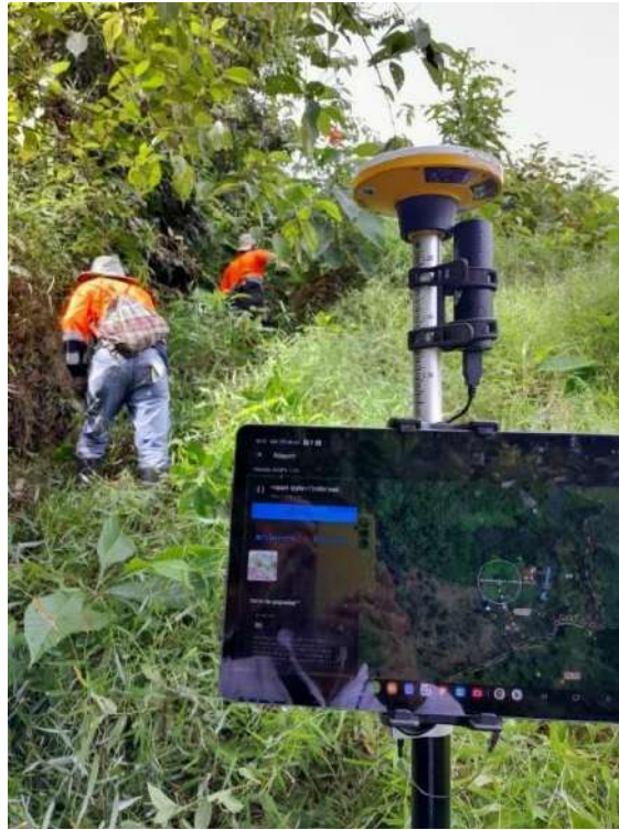
Ilustración 4-4 Equipo de tipo antena marca Trimble Catalyst DA2 de multifrecuencia y tablet
