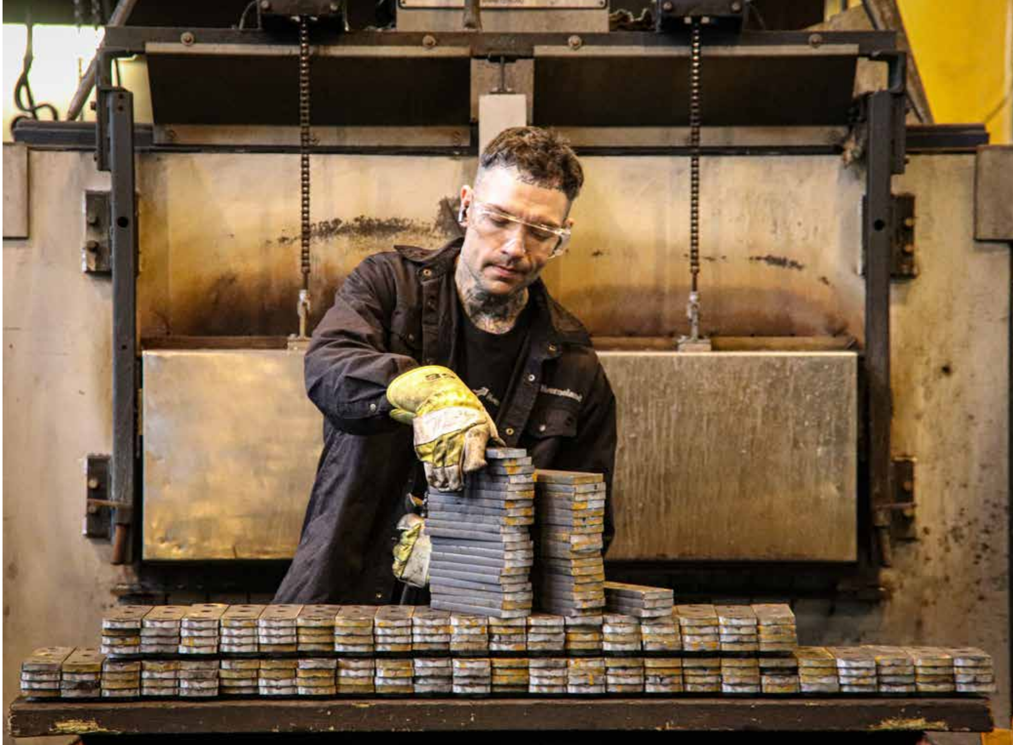
Stålet kommer i lange stykker, og tidlig i prosessen deles det opp i riktige stykker. Det er maskiner og mennesker som utfører arbeidet i skjønn forening.
