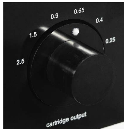
Wzmocnienie regulujemy określając znamionowy poziom wyjściowy stosowanej wkładki.
