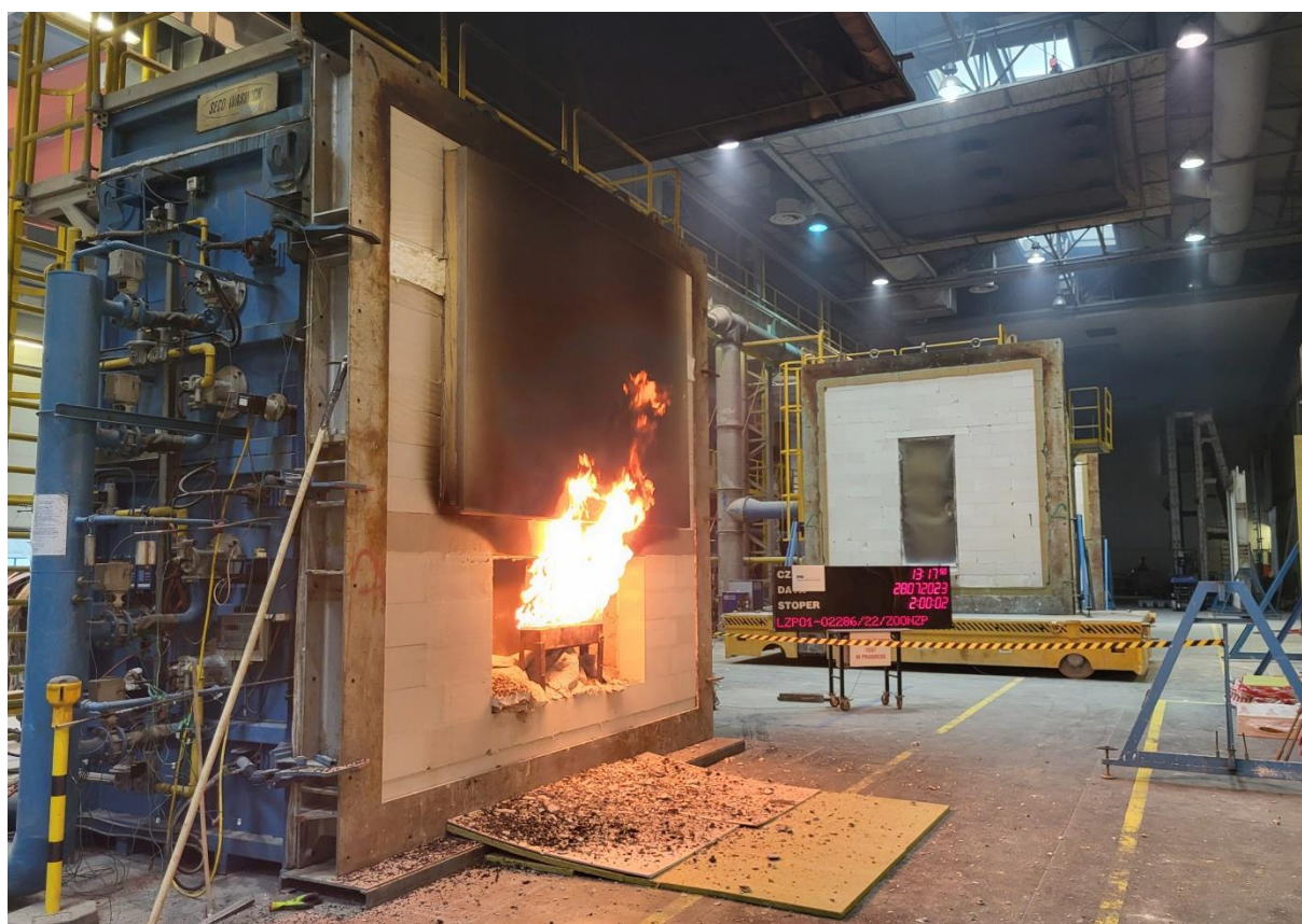
Rys. 11. Element próbny po 120 minutach badania; źródło: [4]
