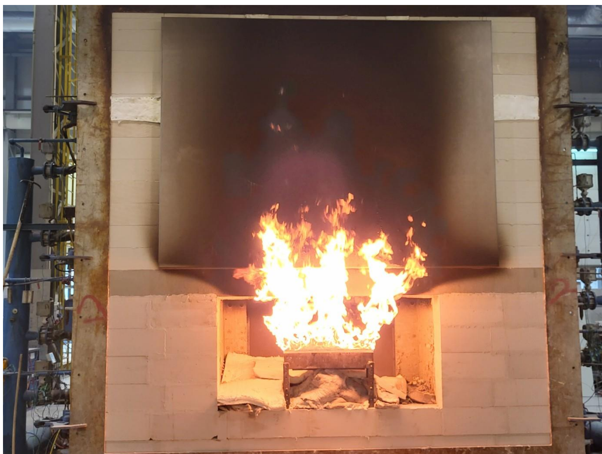
Rys. 15 (Fot. 5) Element próbny w trakcie badania, strona nienagrzewana, t = 60m
