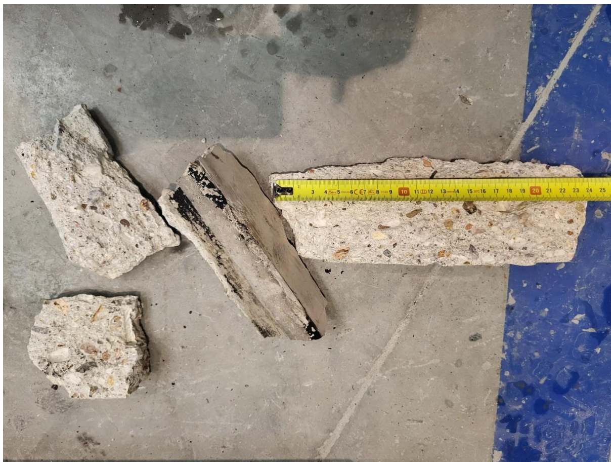
Rys. 16 (Fot. 6) Fragmenty betonu warstwy wewnętrznej, które odpadły w t = 72m\ 34s
