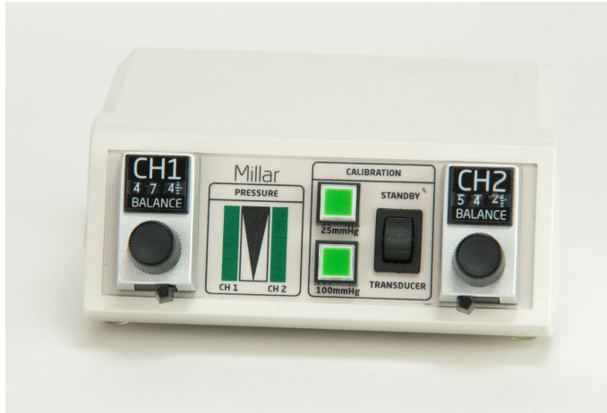
Fig. 1. Panneau de commande avant de l'unité MPS-2000
