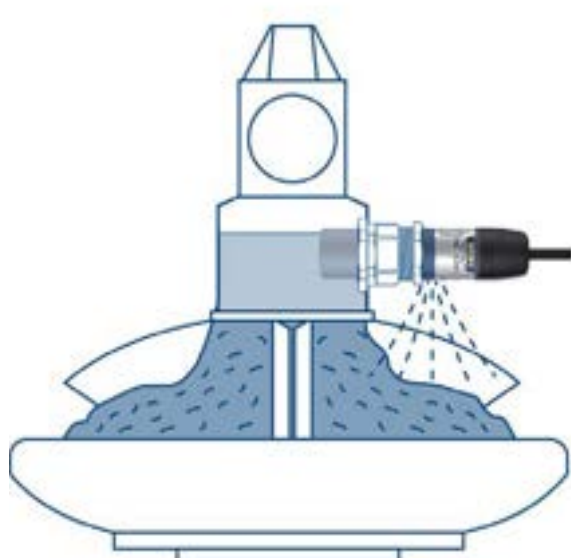
Exemple de DOL 28 monté dans un bac d'alimentation
