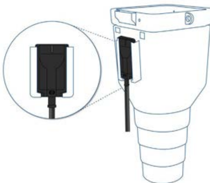
Exemple de montage du DOL 20 dans un tube de descente
