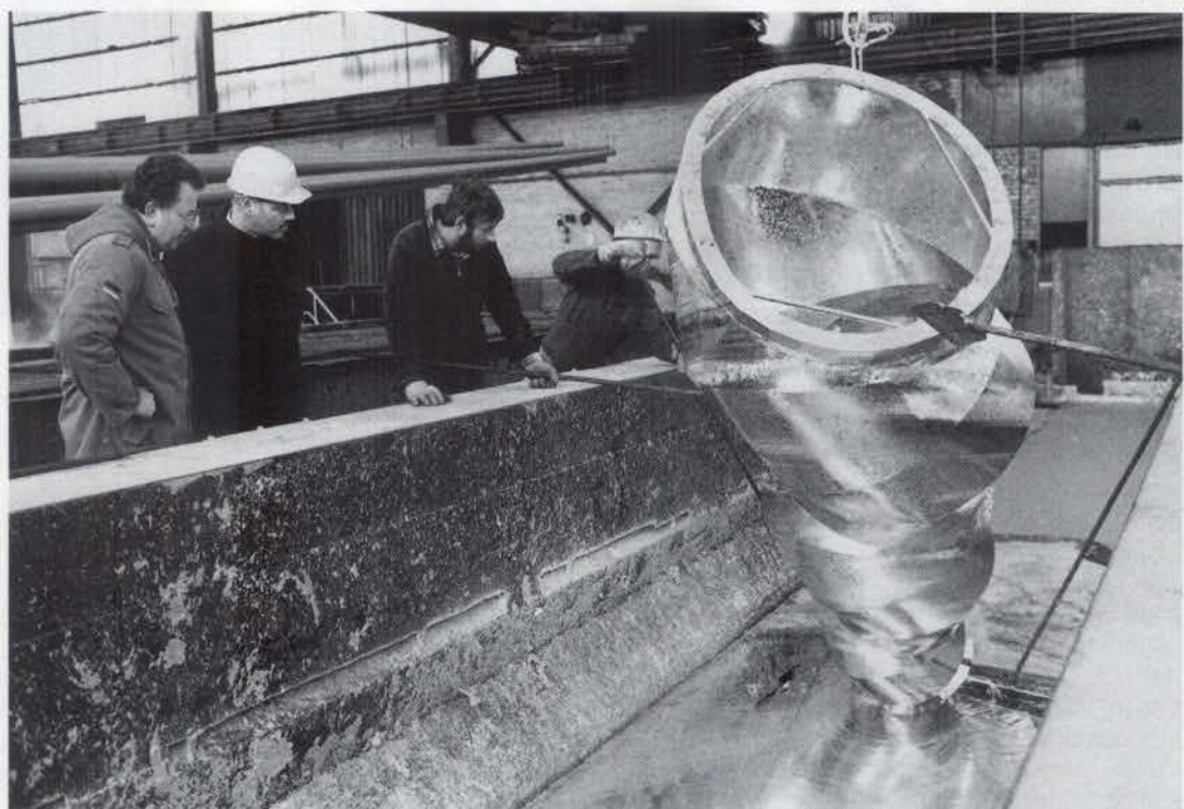
Abb. 15: Eines der drei Skulpturenteile im Zinkbad.
