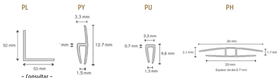
Perfiles fabricados con la misma resina de las placas Lexan Cliniwall C6206.
