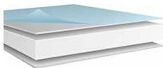
Panel para aplicaciones interiores y exteriores. Núcleo de poliestireno extruido de densidad 30 kg/m<sup>3</sup> BLANCO, encerrado entre dos láminas de PVC de 1 mm de espesor BLANCAS densidad 0,80 kg/m<sup>3</sup>. Protegido ambos lados por una película de polietileno
