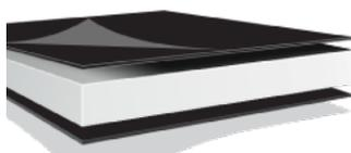
Panel para aplicaciones interiores y exteriores. Núcleo de poliestireno extruido de densidad 30 kg/m<sup>3</sup> BLANCO, encerrado entre dos láminas de PVC de 1 mm de espesor NEGRAS densidad 0,80 kg/m<sup>3</sup>. Protegido ambos lados por una película de polietileno
