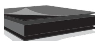
Panel para aplicaciones interiores y exteriores. Núcleo de poliestireno extruido de densidad 30 kg/m<sup>3</sup> NEGRO, encerrado entre dos láminas de PVC de 1 mm de espesor NEGRAS densidad 0,80 kg/m<sup>3</sup>. Protegido ambos lados por una película de polietileno.
