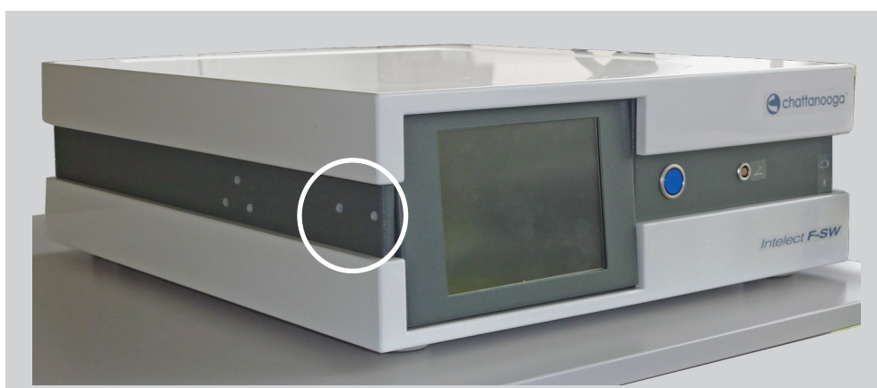
Fig. 4-8 Fori per il fissaggio del braccio di ritenzione
