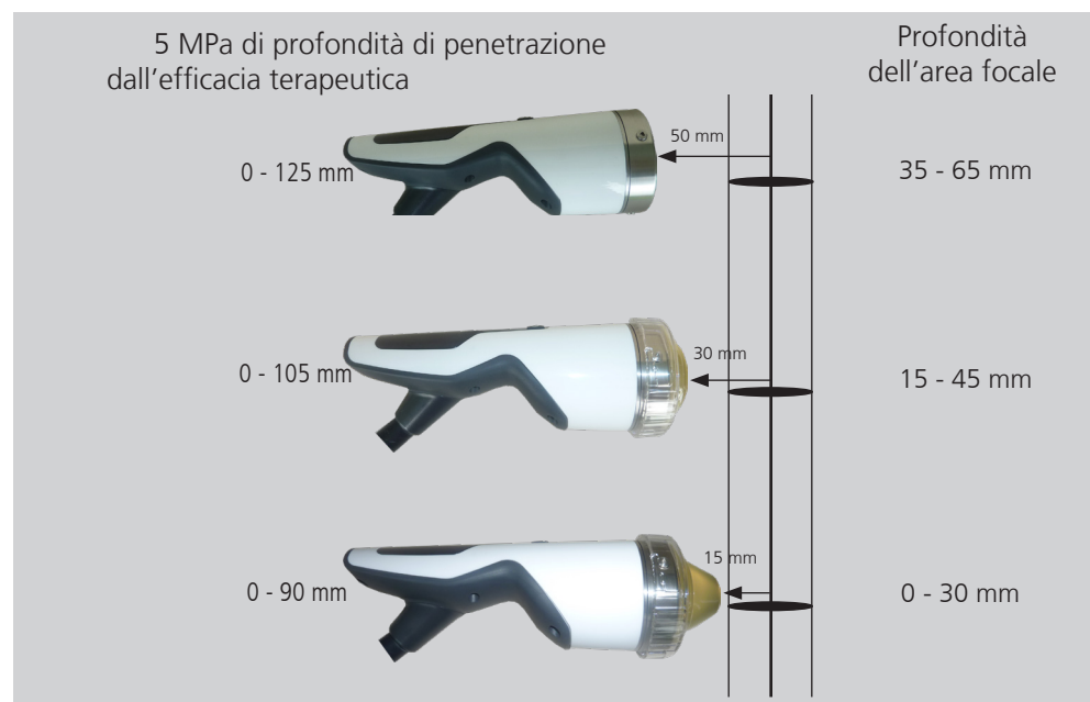
Fig. 3-5 Profondità dell'effetto terapeutico del manipolo F-SW
