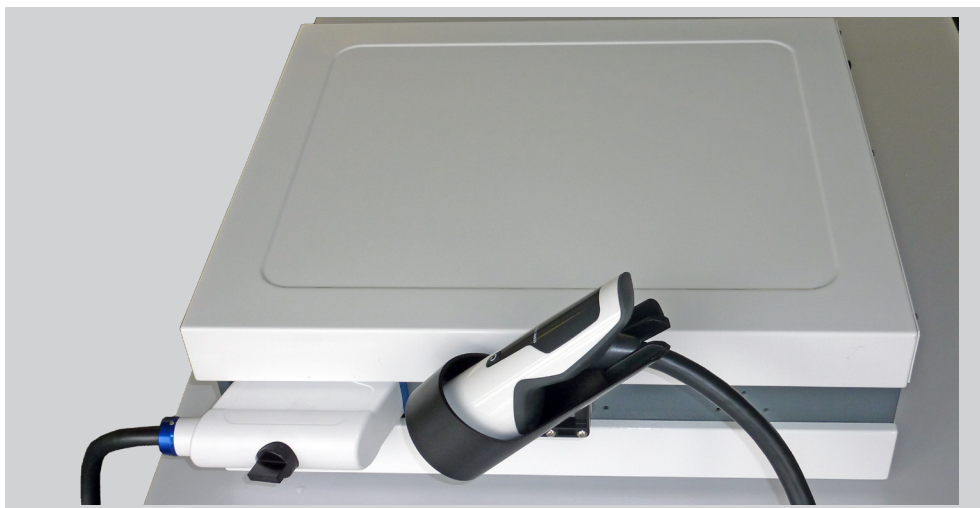
Fig. 5-48 Posizione corretta del manipolo
