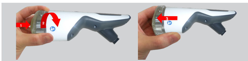
Fig. 6-51 Per smontare il dispositivo trasmettitore
