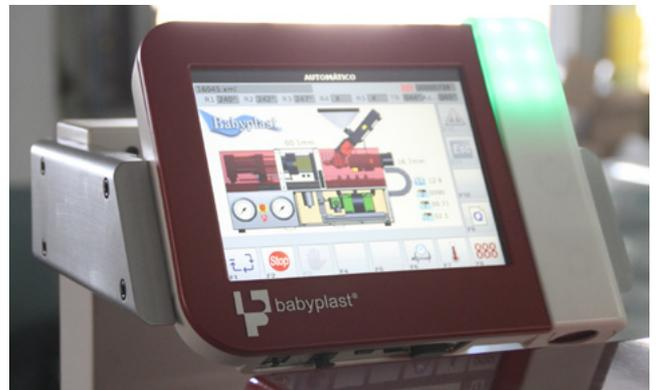
Img 6: Detalle centro de control de máquina de inyección.
