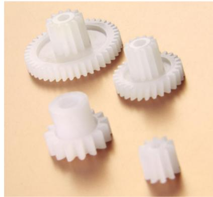
Img 4: Engranajes de plástico fabricados con inyectoras de CLR.
