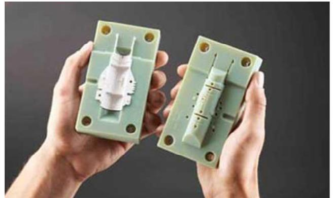
Img 10: La impresora 3D Objet500 de Stratasys puede crear moldes de inyección utilizando ABS Digital.
