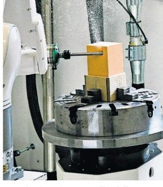
...und schon legt „Goliath“ mit größter Präzision los, so dass die Polyurethan-Späne umher fliegen...
