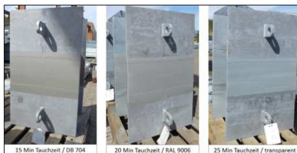
Bild 20: Fertiggestellte Arbeitsproben der Montageschweißstöße mit thermisch gespritztem und versiegeltem Überzug im Bereich der Schweißnaht (IKS)
