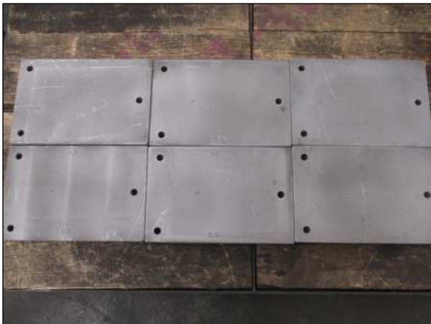
Bild 27: Ergänzende Arbeitsproben / Blechproben (vor dem Feuerverzinken) mit verschiedenen Oberflächenbearbeitungen der Brennschnittflächen (Fa. Rädlinger)
