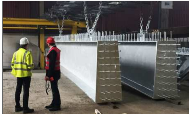
Bild 31: Qualitätskontrolle der fertigen feuerverzinkten Brückensegmente (IFG)
