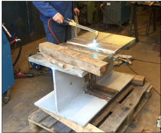
Bild 24: Arbeitsproben - Herstellung des Montageschweißstoßes (IFG)
