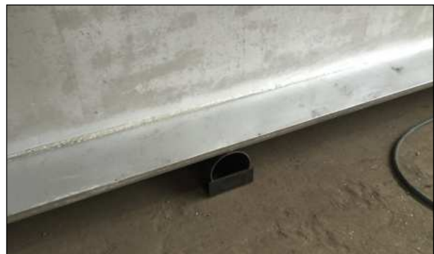
Bild 37: Auf den mittig positionierten Absetzböcken abgelegtes Bauteil (IFG)
