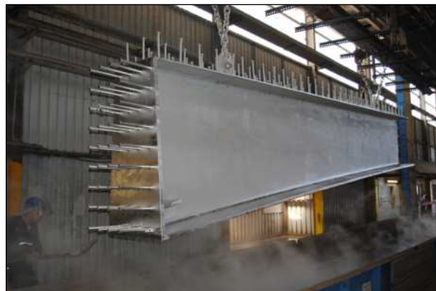
Bild 33: Äußeres Brückensegment nach dem Feuerverzinkungsprozess (IFG)
