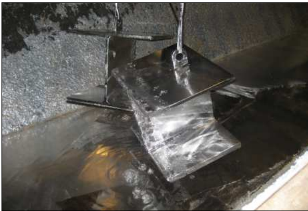
Bild 22: Feuerverzinken der Arbeitsproben (IFG)
