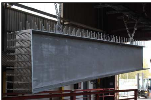
Bild 18: Angeschlagenes feuerverzinktes Brückenteil (IFG)
